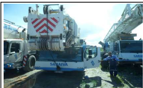
499 - GUINDASTE TELESCOPIO LIEBHERR LTM1500-8.1 2011
