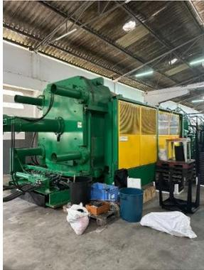
1 MÁQUINA INJETORA- DEMAG 1.350 TON
